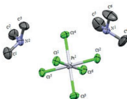
Методом рентгеноструктурного анализа (РСА) установлено строение комплекса 1. Кристаллы комплекса 1 состоят из тетраэдрических катионов триметиламмония и гексахлороплатинатных октаэдрических анионов.
